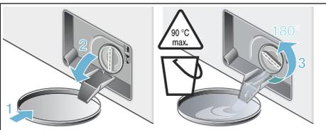
6. Jetzt den Pumpendeckel vorsichtig heraus schrauben. Restwasser kann auslaufen. Innenraum, Gewinde des Pumpendeckels und Pumpengehäuse reinigen. Das Flügelrad der
